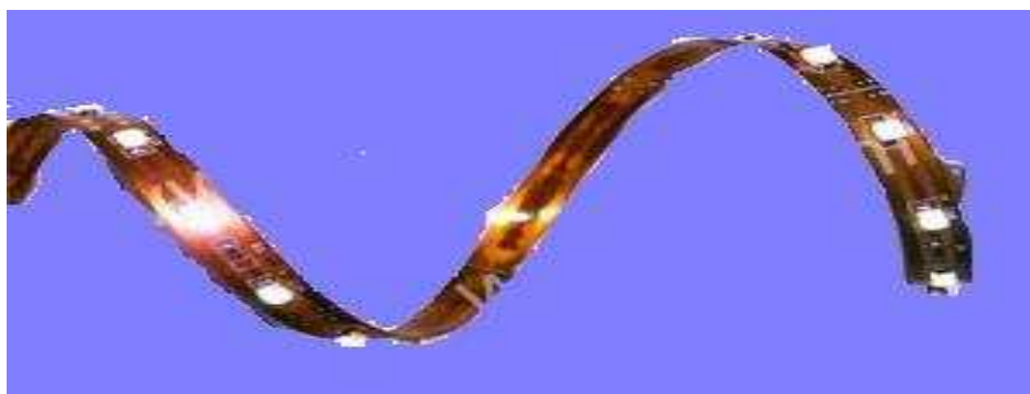
Flexible LED-Leiste, trennbar nach 3 SMD-LED
